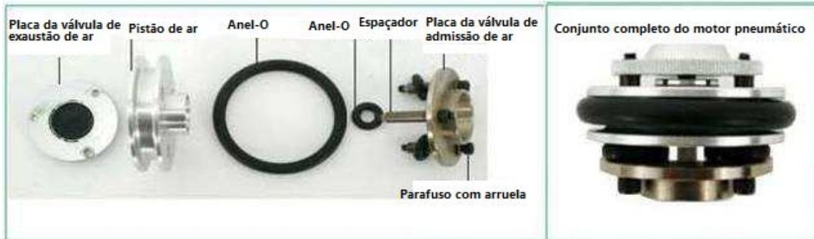
2. Monte o conjunto completo do motor pneumático novamente usando o trava-rosclas com arruela no eixo do pistão. Aperte apenas manualmente.
