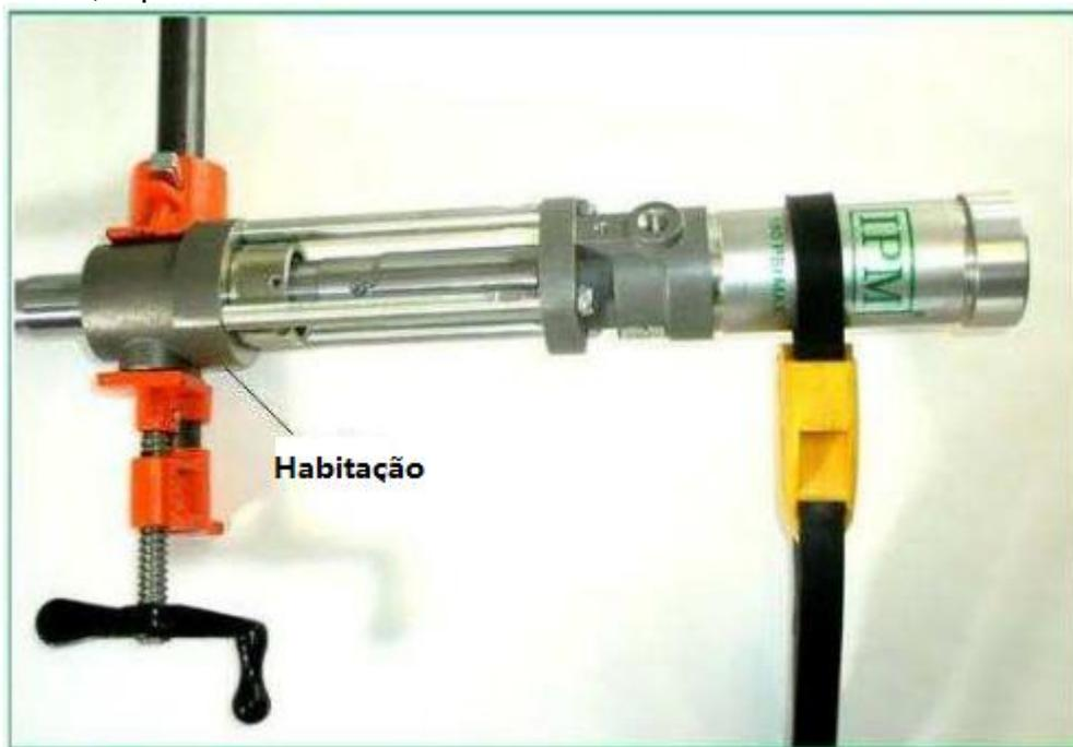
3. Remova a válvula de pé, enquanto segura o cilindro de ar com uma chave de cinta, conforme mostrado.
