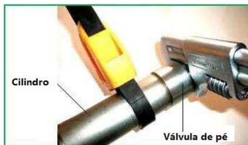
**UMA NOTA SOBRE VÁLVULAS DE PÉ:** Todas as válvulas de pé foram convertidas para uma capacidade de fluxo superior. Este é um elemento de design para reduzir a pressão de saída de gás e de sucção dentro da bomba. Embora as válvulas de pé sejam facilmente intercambiáveis com o modelo mais antigo, os componentes internos não são, portanto, tome cuidado ao solicitar peças de reposição.
