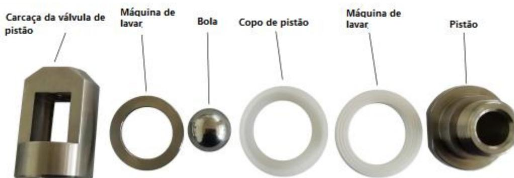
10. Monte novamente a porca hexagonal na haste de conexão. Instale o conjunto do alojamento da válvula do pistão na biela. Ajuste o alojamento da válvula do pistão de forma que a tolerância entre a biela e a válvula do pistão esteja entre 0,060 "e 0,080" usando um calibrador de folga para precisão.
