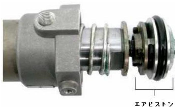
エアシリンダーを取り外した状態のエアモーターアセンブリとピストンロッド。
