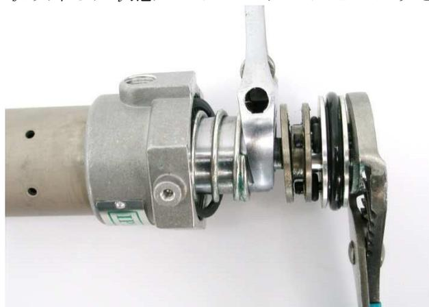
排気バルブプレートの刻み目部分にチャンネルロックプライヤーを取り付け、平面にレンチを取り付けて、エアピストンアセンブリを取り外します。エアモーターキャップのスプリングを調べて、破損していないか緩んでいないことを確認します。エアモーターキャップのガスケットを調べ、必要に応じて交換します。このガスケットは、シリンダーキャップをエアシリンダーにシールします。また、下部のリターンスプリングを点検して、エアモーターベースアセンブリに正しく固定されていることを確認してください。
