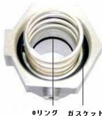
2. エアモーターベースの機械加工された溝の中にOリングを配置します。スプリングをエアモーターベースの中央に配置し、エアモーターベースの上部に配置します。ピストンロッドとエアバルブアセンブリをエアモーターベースにスライドさせます。
