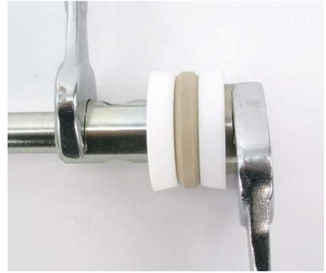
分解された内部フットバルブ. 分解したら、各部品を清掃および検査し、損傷・摩耗している部分は、再組み立ての前に部品を交換します。再インストール時にスレッドロッカーを使用してください。
