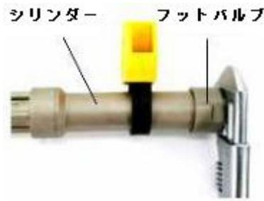
1. ストラップレンチでシリンダーを保持しながらフットバルブを取り外します。
