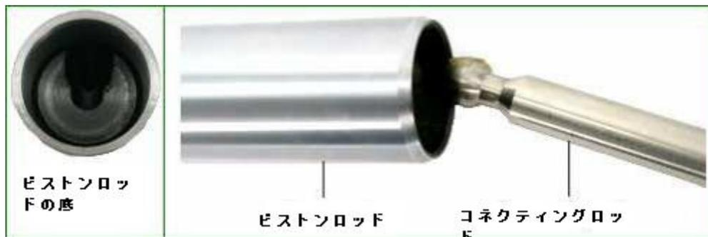
ピストンロッドはエアモーターアセンブリの内側にあります。上の図では取り外されているので、詳細を確認できます。
