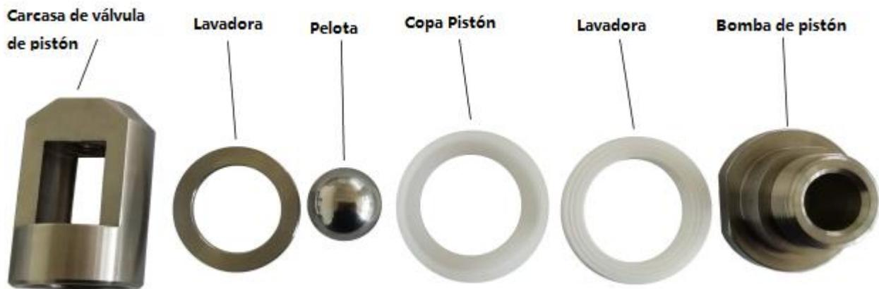
10. Vuelva a montar la tuerca hexagonal en la biela. Instale el conjunto de la carcasa de la válvula del pistón en la biela. Ajuste la carcasa de la válvula del pistón de modo que la tolerancia entre la biela y la válvula del pistón esté entre 0.060" y 0.080" usando un calibre de espesores para mayor precisión.
