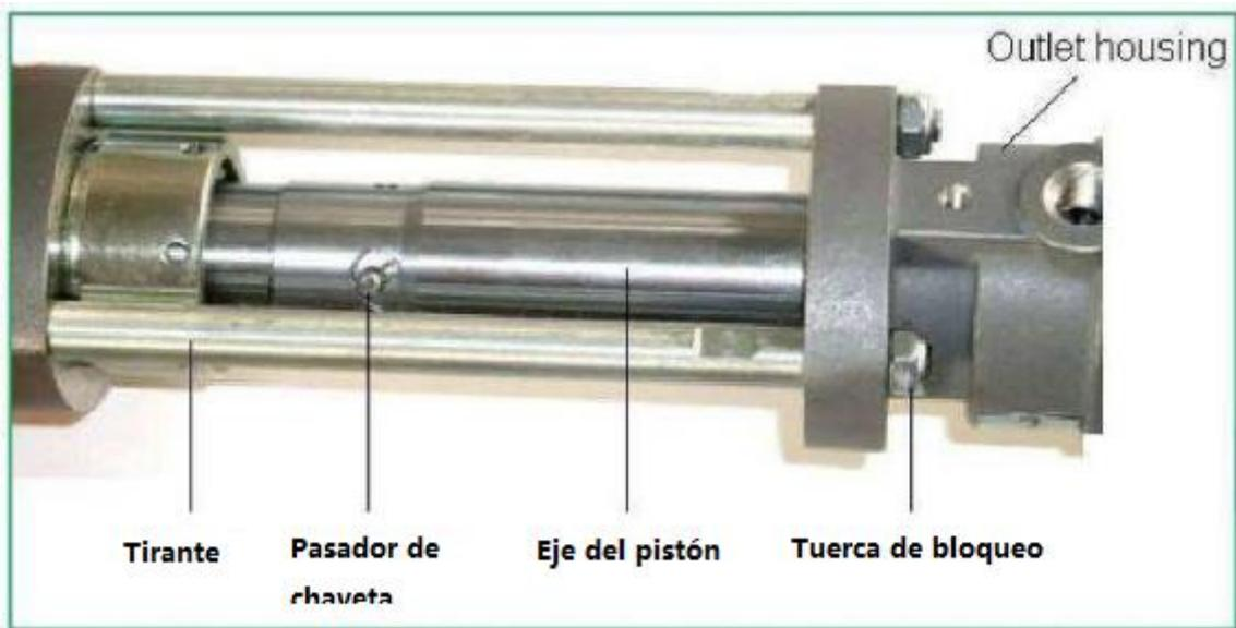
12. Desde la sección del motor neumático, retire el pasador de chaveta y luego retire el pasador de cabeza plana. Desatornille la varilla de desplazamiento del eje del pistón, como se muestra en el diagrama anterior.
