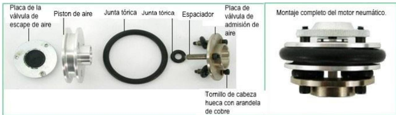
2. Vuelva a montar el conjunto completo del motor neumático utilizando un fijador de roscas con arandela en el eje del pistón. Apriete a mano solamente.
