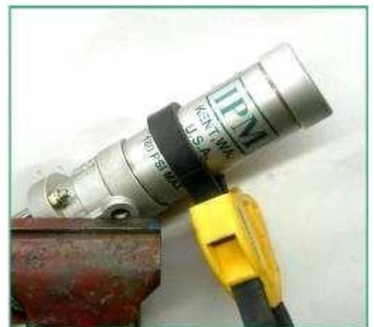
15. Desde la sección de fluido, desatornille la varilla de desplazamiento del eje del pistón. Examine la acumulación de escombros o daños. Vuelva a montar el silenciador con la punta del cono hacia arriba dentro del eje del pistón. Atornille la varilla de desplazamiento en el eje del pistón.
