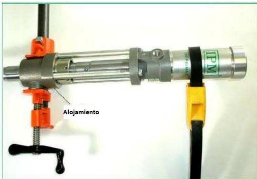
3. Quite la válvula de pie, mientras sostiene el cilindro de aire con una llave de correa como se muestra.
