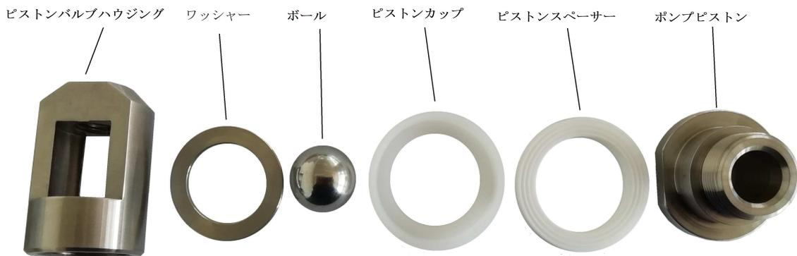
10. 六角ナットをコネクティングロッドに再組み立てします。ピストンバルブハウジングアセンブリをコネクティングロッドに取り付けます。すきまゲージを使用して、コネクティングロッドとピストンバルブの間の公差が 0.060 インチから 0.080 インチになるように、ピストンバルブハウジングを調整します。
