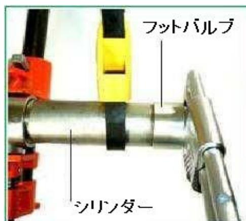
6. この時点で、置換ロッドからコネクティングロッドを取り外すか、コネクティングロッドから内部チェックバルブを取り外すことができます。通常、内部チェックバルブアセンブリを分解して検査および清掃します。
