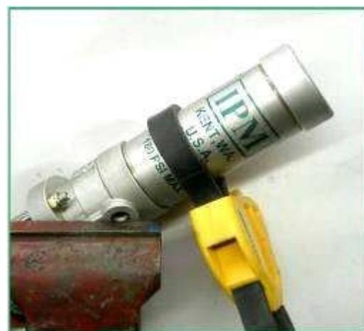
15. 流体セクションから、ピストンシャフトから変位ロッドを緩めます。破片の蓄積や損傷がないか調べます。コーンの先端がピストンシャフトの内側を上に向けてマフラーを組み立て直します。変位ロッドをピストンシャフトにねじ込みます。
