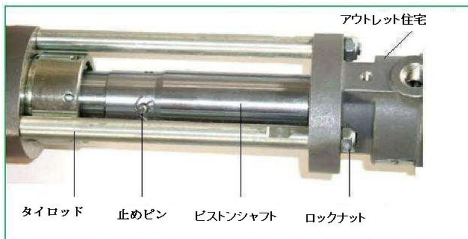
12. エアモーター部から割りピンを外し、フラットヘッドピンを外します。上の図に示すように、ピストンシャフトから変位ロッドを緩めます。
