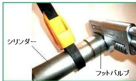
4. スナップリングプライヤーを使用して、スナップリングとEクリップを取り外します。チェックボールを取り外し、フットバルブに破片や損傷がないか調べます。必要に応じて交換してください。テフロンOリングを交換し、フットバルブをボール、スナップリング、Eクリップに再組み立てします。
