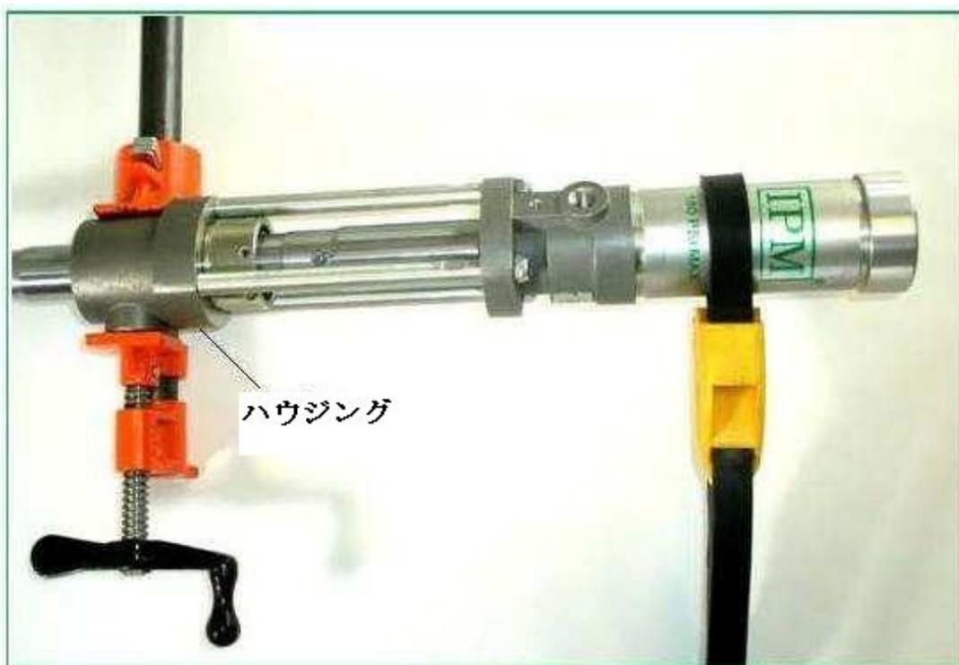
3. 図のようにストラップレンチでエアシリンダーを保持しながら、フットバルブを取り外します。
