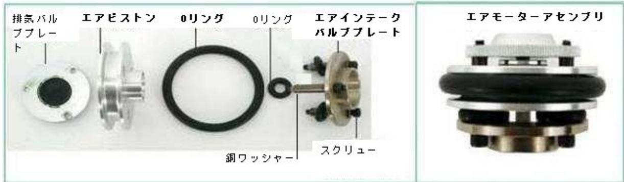
2. ワッシャー付きスレッドロッカーを使用して、エアモーターアセンブリ全体をピストンシャフトに再度組み立てます。手で締めるだけです。
