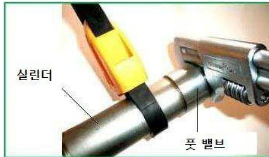
4. 스냅 링 플라이어를 사용하여 스냅 링과 E- 클립을 제거하십시오. 체크 볼을 제거하고 풋 밸브에 이물질 및 / 또는 손상이 있는지 검사합니다. 필요에 따라 교체하십시오. Teflon O- 링을 교체하고 풋 밸브를 볼, 스냅 링 및 E- 클립으로 재 조립합니다.
