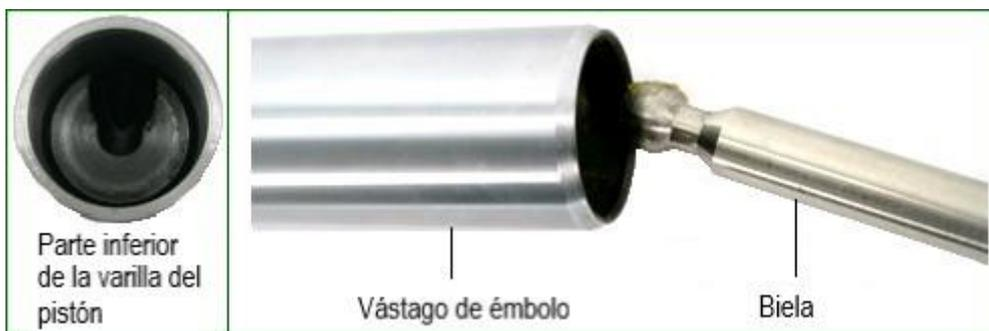
El vástago del pistón está dentro del conjunto del motor neumático, que se ha quitado en la ilustración anterior para que pueda ver más detalles.
