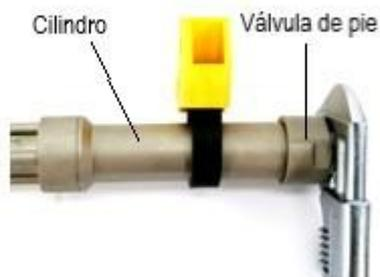
1. Retire la válvula de pie mientras sostiene el cilindro con una llave de correa.
