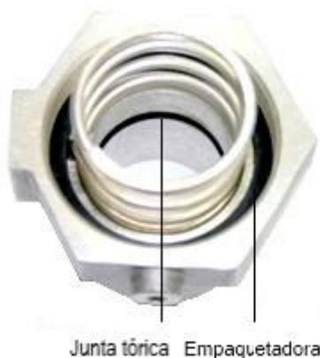
2. Coloque la junta tórica dentro de la ranura maquinada en la base del motor neumático. Coloque la junta en la parte superior de la base del motor neumático con el resorte centrado dentro de la junta, descansando sobre la base del motor neumático. Deslice el conjunto de vástago del pistón y válvula de aire en la base del motor de aire.
