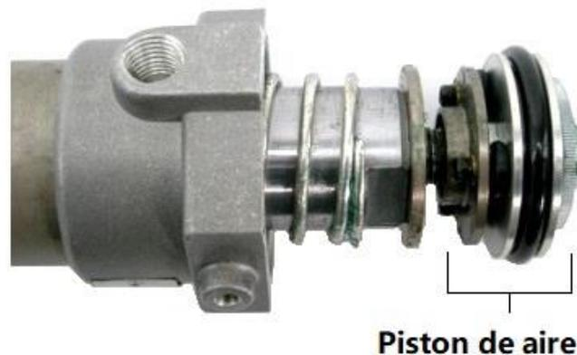
Conjunto del motor neumático y vástago del pistón con el cilindro neumático retirado.
