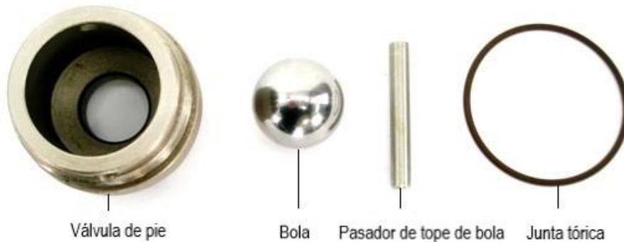
**Partes de la válvula de pie inferior.** En la versión corta de la bomba IP02 hay roscas de tubería hembra de  $\frac{3}{4}$  "debajo de la válvula de pie; en la longitud del tambor no las hay. Si necesita extenderse más en su contenedor, se recomienda instalar un tubo de extensión del cilindro para mantener la válvula de pie en el punto más bajo posible.
