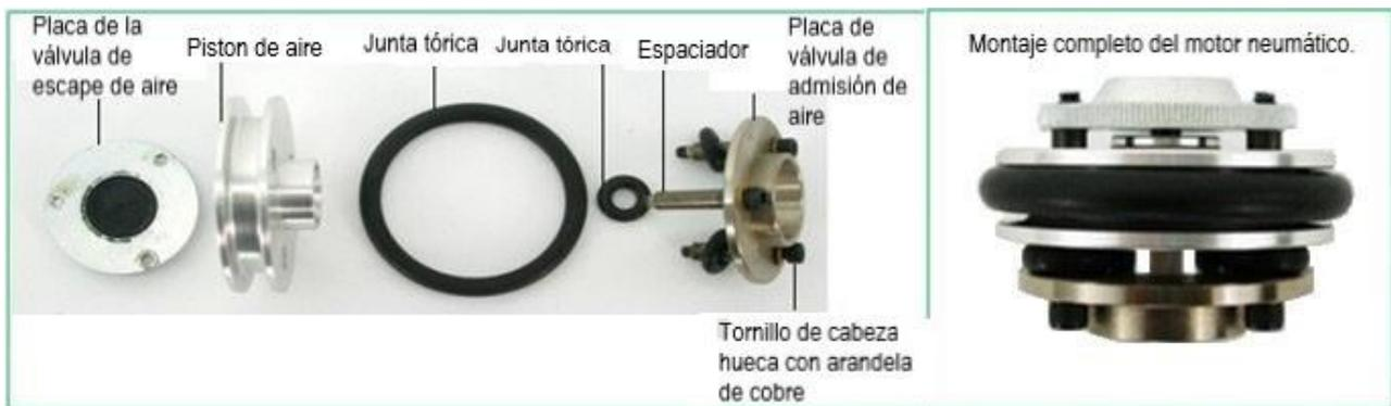
1. Monte el conjunto del pistón de aire (use sellador de roscas), con la arandela en la varilla del pistón. Apriete a mano solamente.
