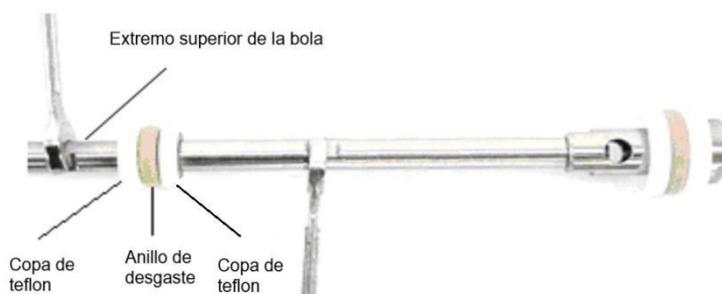
3. Utilice dos llaves y desmonte la sección superior de la bomba. Tenga en cuenta la orientación de las copas de teflón. Uno mira hacia arriba, seguido de un anillo de desgaste en el centro y la segunda copa mira hacia abajo seguido de una arandela de soporte inferior. Use fijador de roscas cuando vuelva a instalar.
