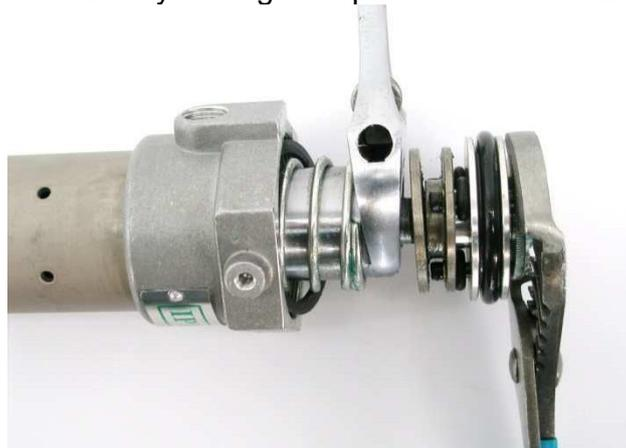
Coloque un par de alicates de bloqueo de canal en el área moleteada de la placa de la válvula de escape y una llave inglesa en las caras planas para quitar el conjunto del pistón de aire. Examine el resorte en la tapa del motor neumático para asegurarse de que no esté dañado o suelto. Examine la junta en la tapa del motor neumático y reemplácela según sea necesario. Esta junta sella la tapa del cilindro al cilindro de aire. También inspeccione el
