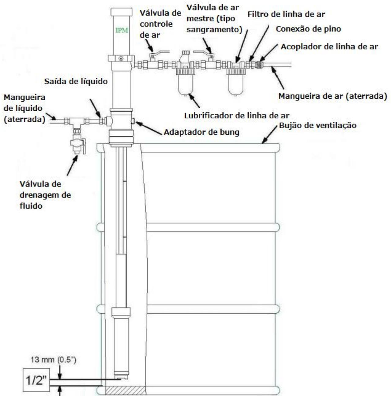
Figura B descreve apenas uma instalação típica, fornecendo um guia para sua referência, mas muitos outros métodos de instalação podem ser usados com base em sua aplicação específica. Algumas peças mostradas não estão incluídas, mas são vendidas separadamente. Sinta-se à vontade para ligar para seu Distribuidor Local para obter assistência.
