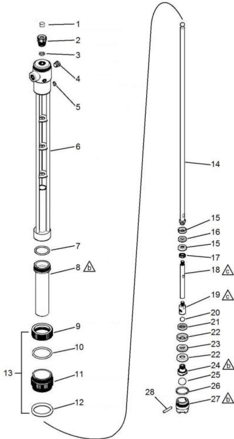
△<sub>b</sub> Torque para 30-35 ft-lbs (41-48 N•m)
