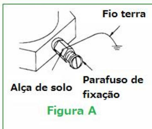
1. Compressor de ar: Siga os procedimentos de aterramento conforme recomendado pelo fabricante do compressor.
