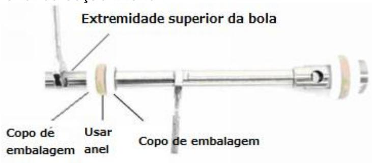
3. Use duas chaves e desmonte a seção superior da bomba. Observe a orientação dos copos de Teflon. Um com a face para cima, seguido por um anel de desgaste no centro e o segundo copo com a face para baixo seguido por uma arruela de suporte inferior. Use threadlocker ao reinstalar.
