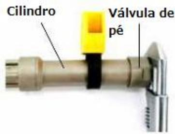
1. Remova a válvula de pé enquanto segura o cilindro com uma chave de correia.
