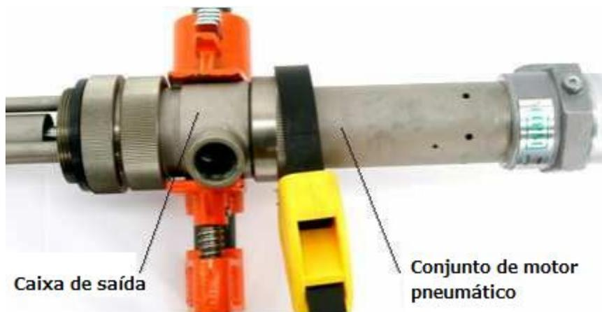
Use uma chave de cinta para remover o conjunto do motor pneumático.
