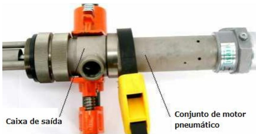
Conecte a seção do motor pneumático ao alojamento da saída, conforme mostrado acima.
