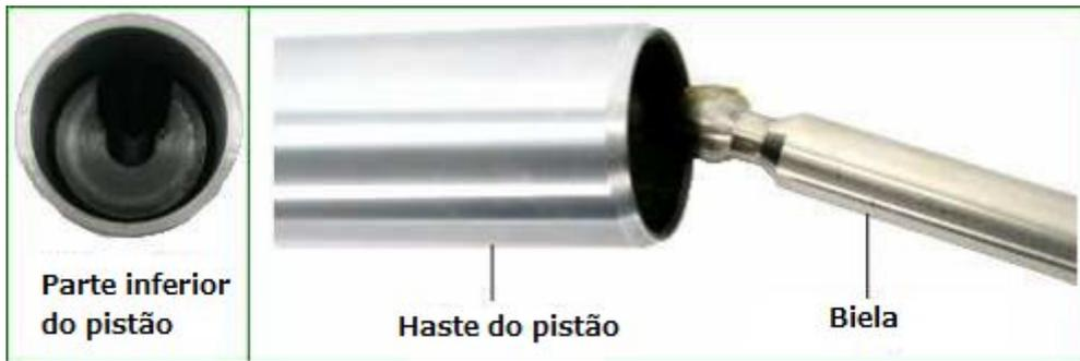
A haste do pistão está dentro do conjunto do motor pneumático - que foi removido na ilustração acima para que você possa ver mais detalhes.
