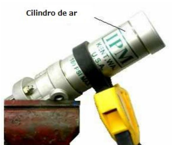
Remova o cilindro de ar manualmente ou usando uma chave de cinta.
