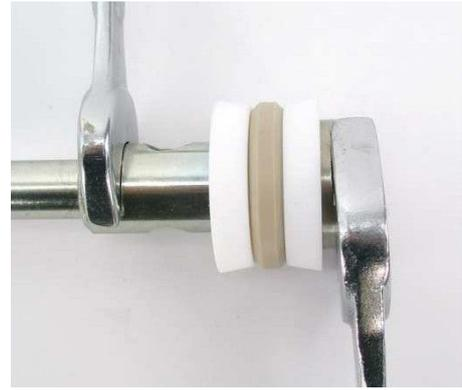
**Válvula de pé interna desmontada.** Depois de desmontado, limpe e inspecione cada peça, substitua todas as peças se danificadas antes de remontar. Use threadlocker ao reinstalar.
