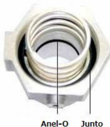
2. Coloque o O-ring dentro da ranhura usinada na base do motor pneumático. Coloque a junta na parte superior da base do motor pneumático com a mola centralizada dentro da junta, apoiada na base do motor pneumático. Deslize a haste do pistão e o conjunto da válvula de ar na base do motor pneumático.
