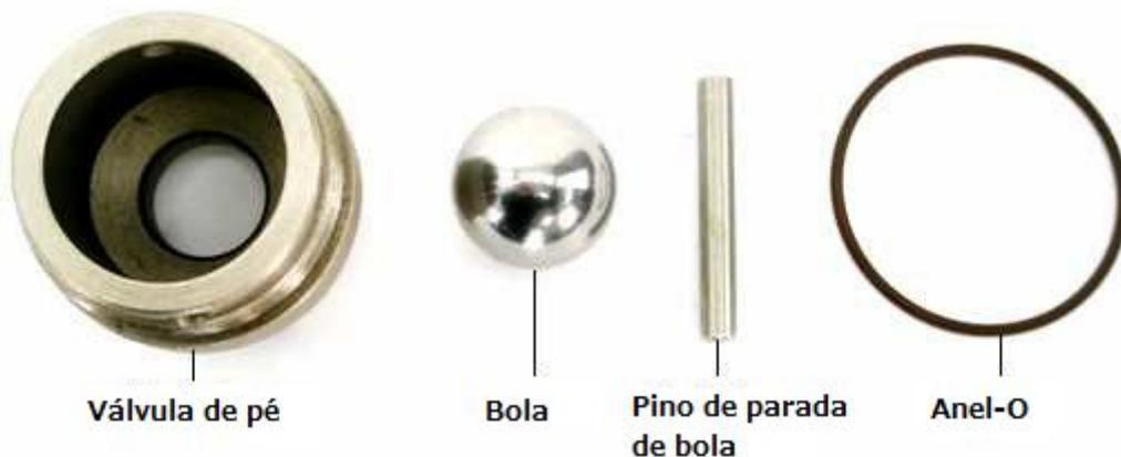
**Peças da válvula de pé inferior.** Na versão atarracada da bomba IP02, há roscas de tubo fêmea de  $\frac{3}{4}$  " sob a válvula de pé - no comprimento do tambor não há. Se você precisar estender o seu contêiner mais longe, é recomendável instalar um tubo de extensão do cilindro para manter a válvula de pé no ponto mais baixo possível.
