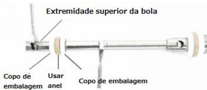
3. Use duas chaves e desmonte a seção superior da bomba. Observe a orientação dos copos de Teflon. Um com a face para cima, seguido por um anel de desgaste no centro e o segundo copo com a face para baixo seguido por uma arruela de suporte inferior. Use threadlocker ao reinstalar.
