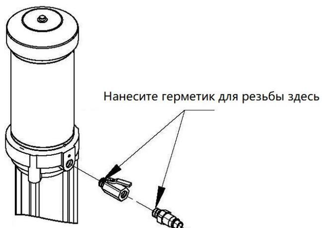
2. Навинтите переходник заглушки на отверстие бараба на.плотно. Осторожно продвиньте перекачивающий насос через адаптер и зафиксируйте его пробкойкрючки защелки адаптера.
