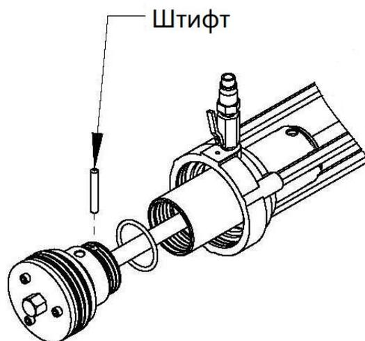
7. Вытолкните поршень через всасывающую трубку.
