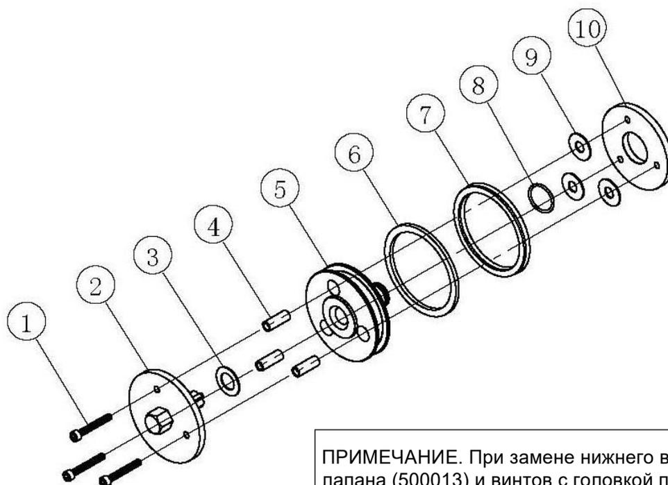
ПРИМЕЧАНИЕ. При замене нижнего воздушного клапана (500013) и винтов с головкой под торцевой ключ (500014) важно использовать жидкий герметик для резьбовых соединений, чтобы предотвратить расшатывание узла.
