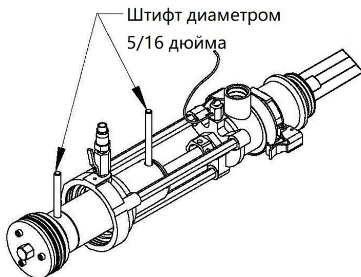
6. Снимите установочный штифт с плунжера. То п. Сборка пневмодвигателя теперь может быть снята с вытеснения поршень.
