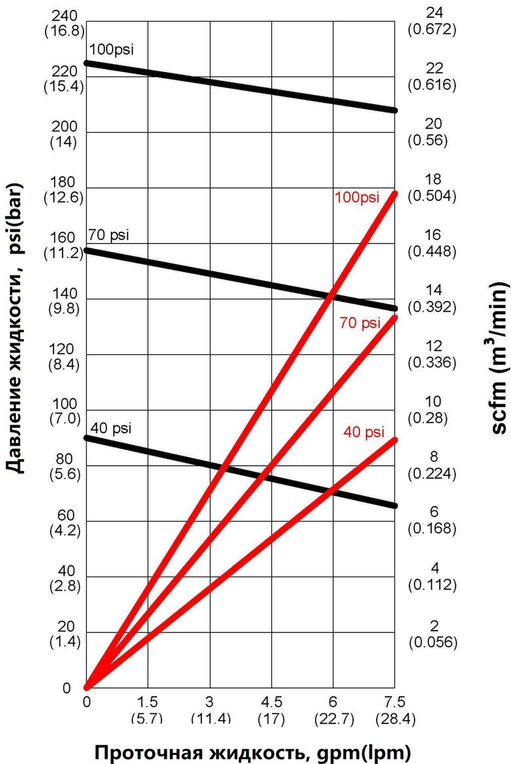
— Кривые давления жидкости (на основе давления воздуха на входе 40,70 и 100 psi)
