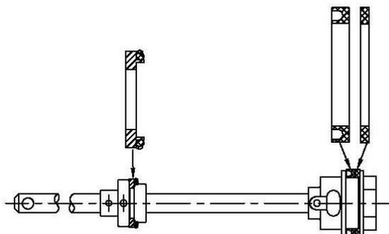
9. Смажьте, установите и соберите детали в обратном порядке. Смазку рекомендуется использовать для стенок пневмоцилиндра и всех компонентов узла пневмодвигателя.
