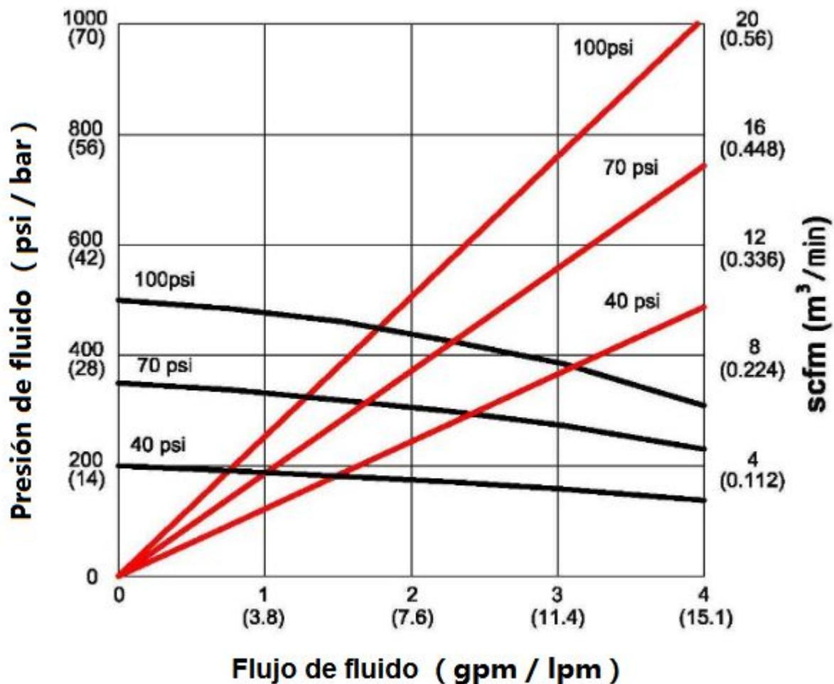
— Curvas de presión de fluido (basadas en la presión de entrada de aire 40,70 y 100 psi)
